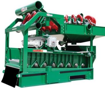
Este **eliminador de sólidos** posee un vibrador de alto impacto para 4 mallas, equipado con dos motores Súper "G" de 2.5 HP y trabaja con 7.0 "G, para limpiar el fluido consta de 2 hidrociclones desarenadores de 10", que procesan 1000 G.P.M. de fluido y sus 20 conos desarcilladores de 4" 1000 GPM.
