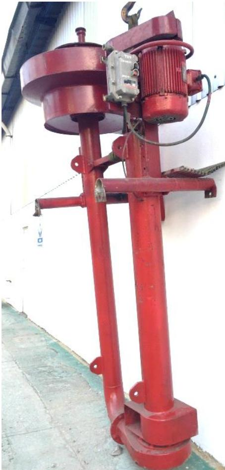
El **degsasificador Atmosférico** remueve el gas contenido en los fluidos de perforación, liberándolo a la atmosfera.
