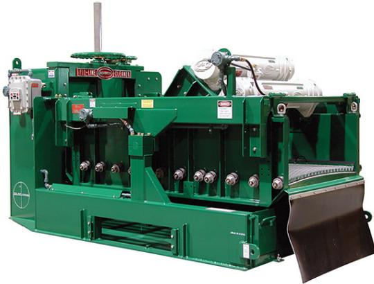
Bajo mantenimiento del **vibrador Derrick**, equipado con dos motores Súper "G" de 2.5 HP cada uno, que permiten operar al vibrador con una fuerza de impacto de 7.0 G y con una duración de más de 35,000 horas operando de manera continua, El modelo Flo line Cleaner con su sistema ajustable mientras perfora (AMP) permite al personal regular el equipo desde -2.5° a +5° grados hacia arriba, dando una mayor flexibilidad. La capacidad de procesamiento de este vibrador es de hasta 560 GPM
