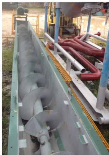
El **Transportador helicoidal** de recorte consta de una sección motriz con motor de 25 H.P. y tornillo helicoidal de 18" tiene la opción de alargarse al unirse 3 o 4 secciones medias con una capacidad de transporte de 200 ton/día
